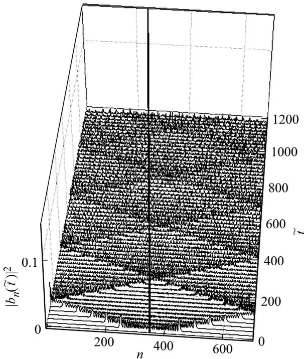
**Рис. 8.** Графики функции  $|b_n(\tilde{t})|^2$  и  $X(\tilde{t})$  при  $\kappa = 1, \eta = 1.276, \omega = 1, \omega' = 1$ , при отсутствии электрического поля для (безразмерного) времени  $\tilde{t} = 1200$ . Длина цепочки  $N = 701$  сайтов. В начальный момент времени заряд находится на одном сайте в центре цепочки,  $u_n^0 = 0$  для всех  $n$ .
