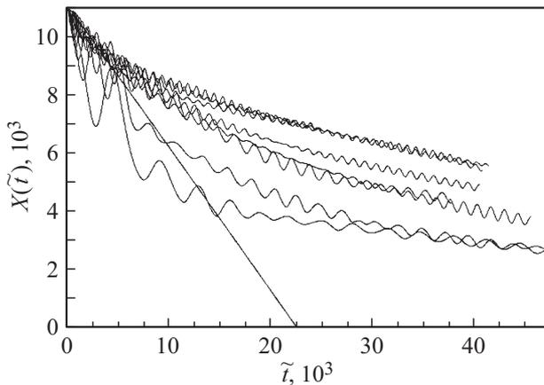
**Рис. 6.** Графики функции  $X(\tilde{t})$  при  $\kappa = 1$ ,  $\eta = 1.276$ ,  $\omega = 1$ ,  $\omega' = 1$  и значениях напряженности электрического поля  $E = 0.001, 0.002, 0.003, \dots, 0.008$  для (безразмерного) времени  $\tilde{t} = 47\,000$ . Длина цепочки  $N = 12\,001$  сайтов.
