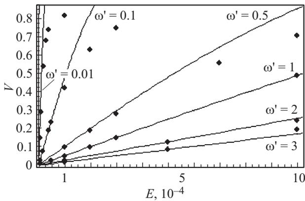
**Рис. 5.** Сравнение „теоретической“ (—) (8), (9) и численной (●) скоростей солитона  $V$  от напряженности электрического поля  $E$  при  $\kappa = 1$ ,  $\omega' = 3, 2, 1, 0.5, 0.1, 0.01, 0$ ,  $\eta = 1.276$ ,  $\omega = 1$  для участков линейной зависимости  $V(E)$ .
