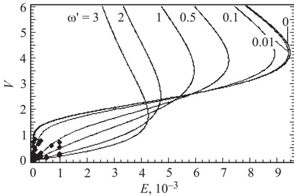
**Рис. 4.** Графики зависимости скорости солитона  $V$  от напряженности электрического поля  $E$  при  $\kappa = 1$ ,  $\omega' = 3, 2, 1, 0.5, 0.1, 0.01, 0$ ,  $\eta = 1.276$ ,  $\omega = 1$ , соответствующие устойчивому движению солитона (при  $dV/dE = V'_E > 0$ ).
